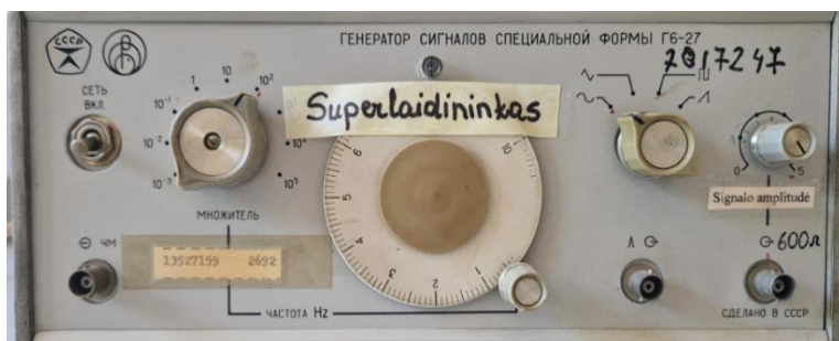
13 pav. Generatorius skirtas pirminės ritės signalo generavimui.
