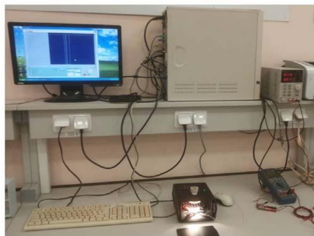
16 pav. Saulės elemento voltamperinės charakteristikos matavimo įranga.
