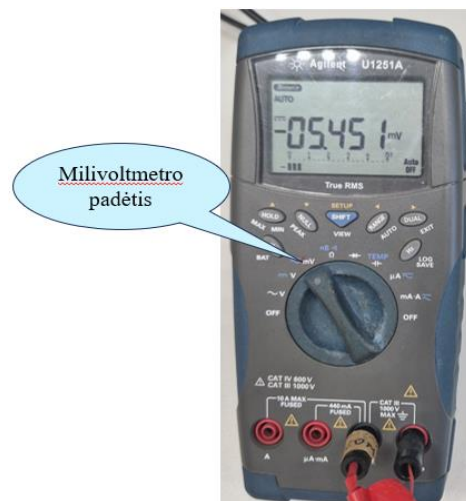
14 pav. Multimetras milivoltu režime.
