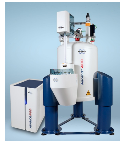
Branduolių magnetinio rezonanso spektrometras (Bruker Ascend 400)
