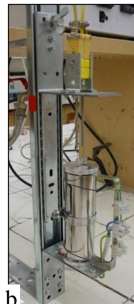
3 pav. DTA įrangos bendras vaizdas (a), krosnies išdėdintas vaizdas (b), temperatūros kontrolės bloko priekinio panelio išdėdintas vaizdas (c).
