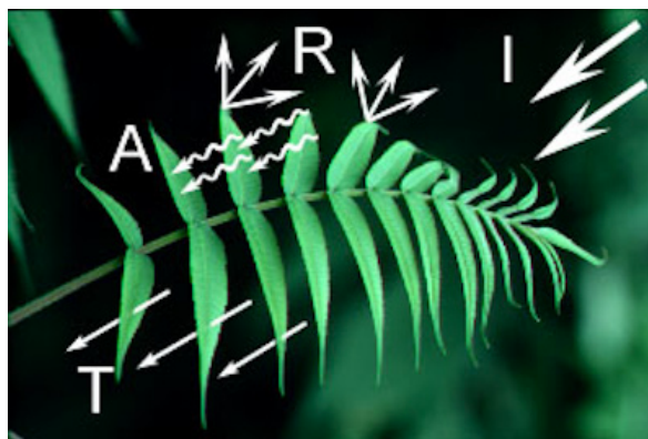
1.2.6. pav. Elektromagnetinės spinduliuotės ir Žemės paviršiaus sąveikos formos: A – sugėrimas; T – perdavimas, R – atspindys (pagal Canada Centre for Remote Sensing, 2009).
