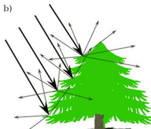
1.2.7. pav. Spinduliuotės atspindžio tipai nuo paviršiaus: a) veidrodinis atspindys, b) sklaidusis atspindys (pagal Canada Centre for Remote Sensing, 2009).
