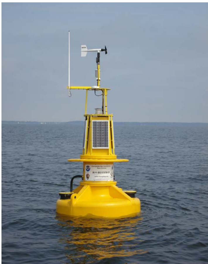
3.5.2. pav. Stacionari vandens telkinio rodiklių stebėjimo buja, naudojama NOAA (NOAA, 2008).
