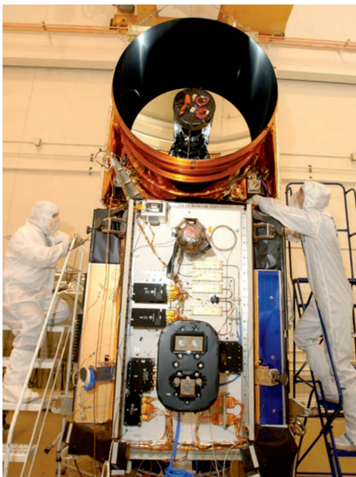
2.3.2. pav. ICESat palydovo lazerinis infraraudonojo spektro altimetras GLAS. Nuotraukoje vaizduojama GLAS prietaiso mechaninis integravimas į ICESat palydovą 2002 m. birželio 18 d. (pagal Zwally ir Santana, 2016).
