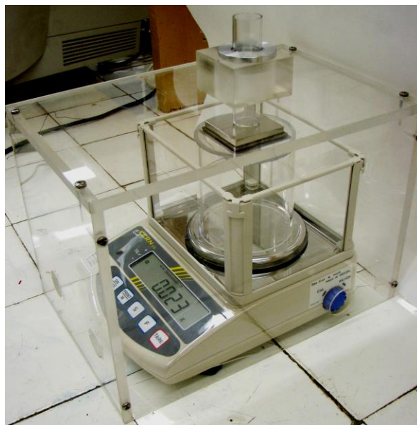
4 pav. Medžiagų magnetinių savybių tyrimo įrangos schema ir bendras vaizdas.
