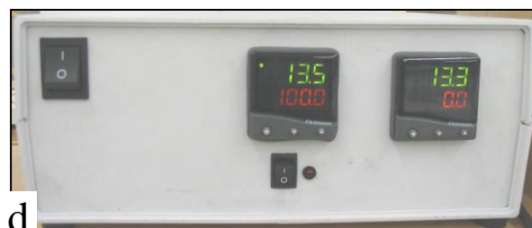
3 pav. DTA įrangos bendras vaizdas (a), krosnies išdėdintas vaizdas (b), kompiuterio ekrano su atidaryta matavimo programa vaizdas (c), temperatūros kontrolės bloko priekinio panelio išdėdintas vaizdas (d).
