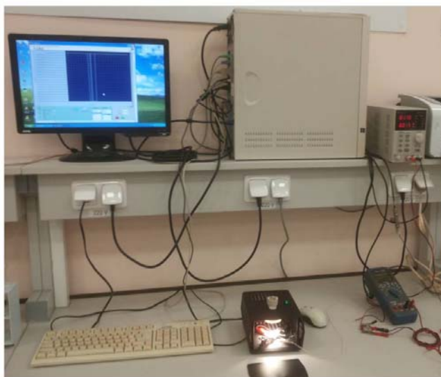
12 pav. Saulės elemento voltamperinės charakteristikos matavimo įranga.
