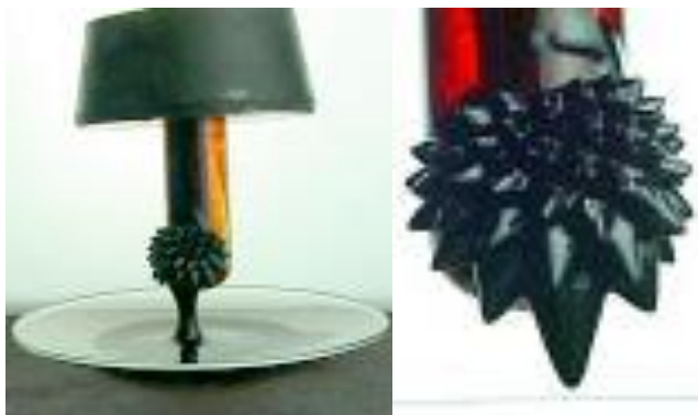
3 pav. Feroskysčio pakėlimas magnetu
