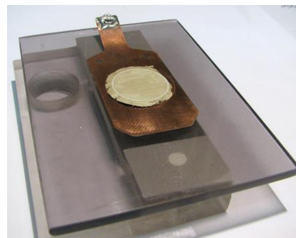
5 pav. Whatman membrana ant varinio elektrodo.
